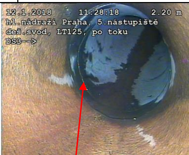
FOTO81: Prasklina v dolní části spadiště
